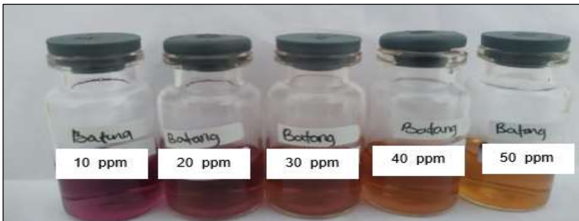
Gambar 1. Uji aktivitas antioksidan etanol Batang Kopasanda ( Chromolaena odorata L.) dengan Metode DPPH
